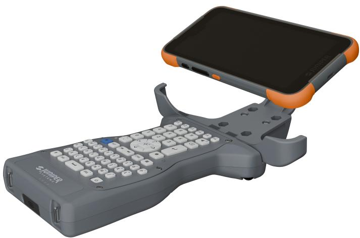
2. Presione hacia abajo y encaje el otro borde del Archer 4 debajo del clip de bloqueo.
