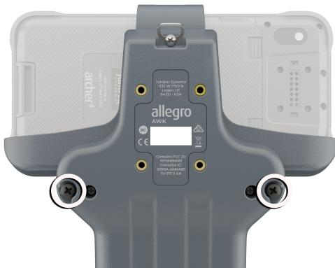
2. Coloque el tornillo a través del lazo en la parte superior de la correa de mano. Inserte el tornillo en el orificio del tornillo. Apriete el tornillo para asegurar el lazo de la correa de mano.
