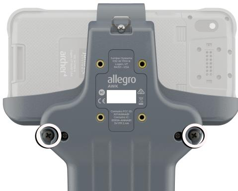
2. Placez la vis dans la boucle en haut de la dragonne. Insérez la vis dans le trou de vis. Serrez la vis pour fixer la boucle de la dragonne.
